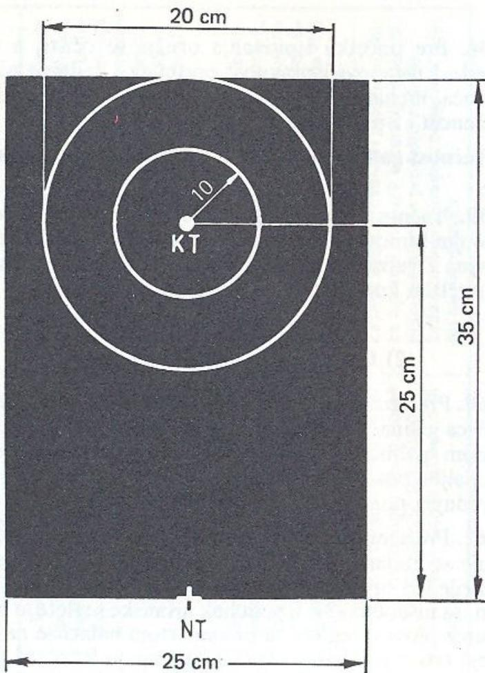
Sl. 66. Meta za ispitivanje tačnosti i preciznosti mitraljeza
